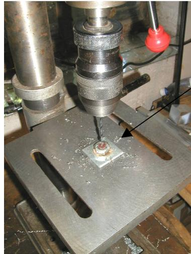
Mit Unterlagsscheiben und Muttern die Schraube an der Bohrunterlage anschrauben um exakt senkrecht zu bohren
