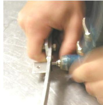
Nun werden die vier Rahmenteile (Ellipse) auf einer ebenen Fläche zusammengeschraubt.
