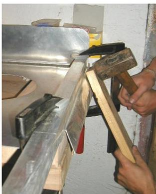
Man erhält sehr schöne Knickfalten, wenn man das Aluminiumblech mit einem Kantholz oder einer Leiste auf die Tischkante herunterspannt. Mit einem Hammer und einem Stück Holz lässt sich die Kante gut biegen.
