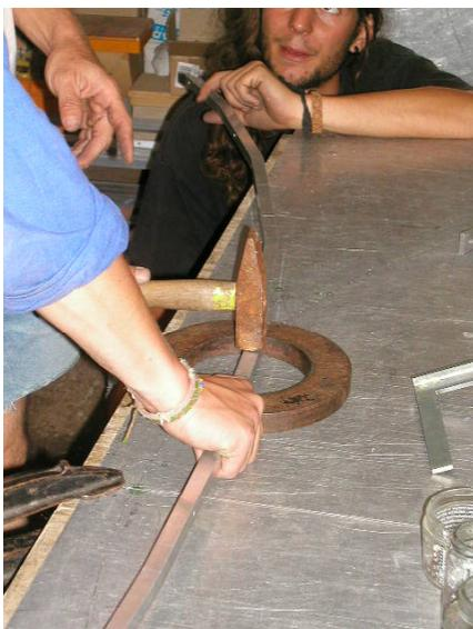
Die gebogene Mittelstange wird nun überprüft, ob sie flach auf einer ebenen Fläche aufliegt. Ebenso müssen die Seiten rechtwinkelig zur Fläche sein! Wenn nötig mit einem Hammer korrigieren (Foto).
