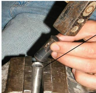
Biege den Rand auf einer Seite von C13 wie im Bild gezeigt. Führe C13 durch das 16mm Loch in S1. Biege nun das andere Ende, so dass das Stahlröhrchen C13 fest im Loch sitzt.
