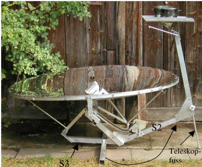
3. **Teleskopfuss** (S16, S11, S9 (mit 12 mm Loch)): Bei der Breite von ~25° kommt S2 flach auf den Boden zu liegen. Von dieser Breite bis hin zum Äquator ist der Teleskopfuss überflüssig.
